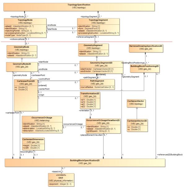
Figure 59: 2D-Geometry
